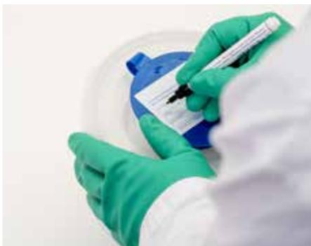
7. Beigefügtes Deckeletikett aufkleben. Die vollständig ausgefüllten Ansatzinformationen (Produktname, Konzentration, Einwirkzeit, Charge, Ansatz) eintragen.
